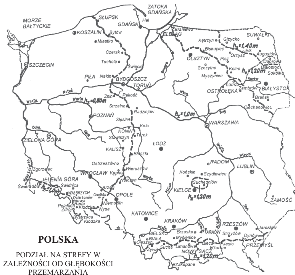
Rys. 4.2.1. Głębokość przemarzania gruntu w Polsce wg PN-81/B-03020
